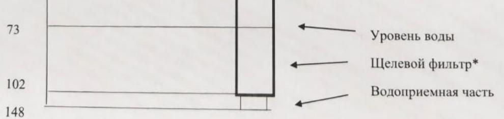
\*Щелевой фильтр со слов Заказчика. Определить промежуток с помощью погружной видеокамеры не удалось
